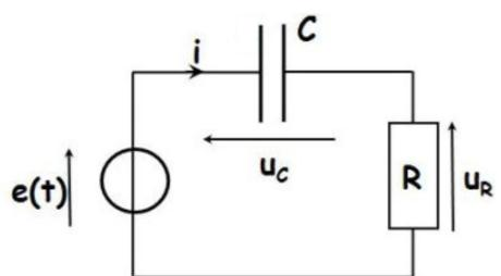
1. Exprimer la tension aux bornes de l'ensemble résistance-condensateur, notée  $e(t)$ .
