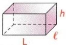
Le volume d'un parallélépipède rectangle de longueur  $L$ , de largeur  $l$  et de hauteur  $h$  est donné par :
